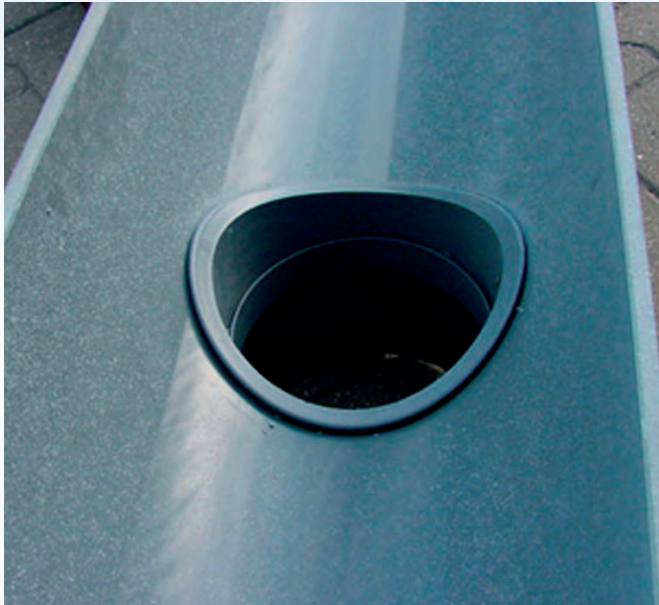
Widok od wewnątrz po „hamburskiej” próbie płukania
