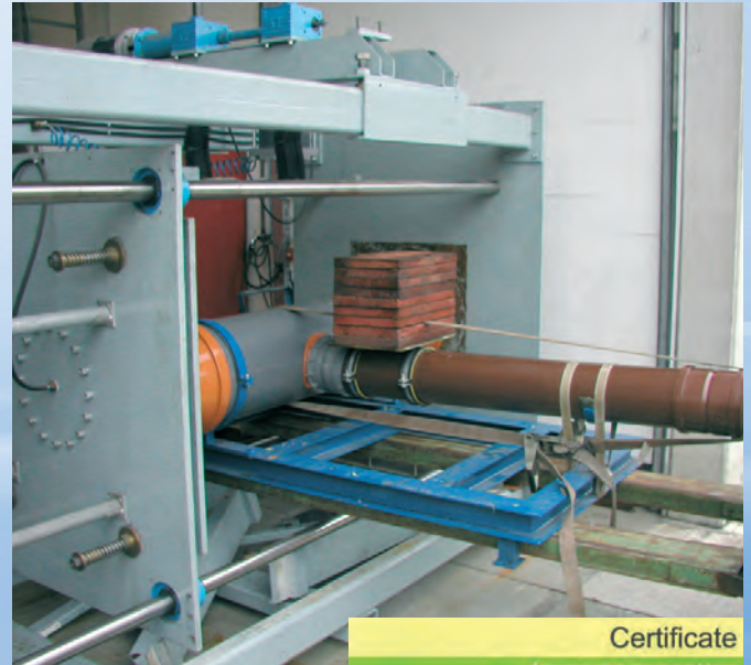
Stanowisko do przeprowadzenia próby na siły ścinające
