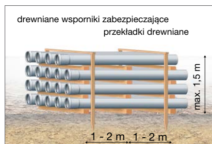
a) składowanie z zastosowaniem przekładek
