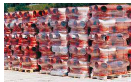
Studzienki kanalizacyjne w zgrzewkach
