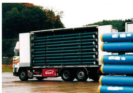
Prawidłowy przewóz rur z PVC
