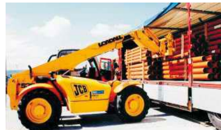
Preferowany sposób rozładunku pakietu rur kanalizacyjnych
