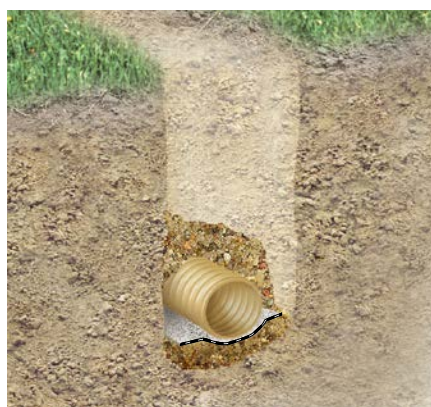
I stopień zagrożenia: poniżej drenu warstwa włókniny; powyżej obsypka z materiału sypkiego (żwiru)
