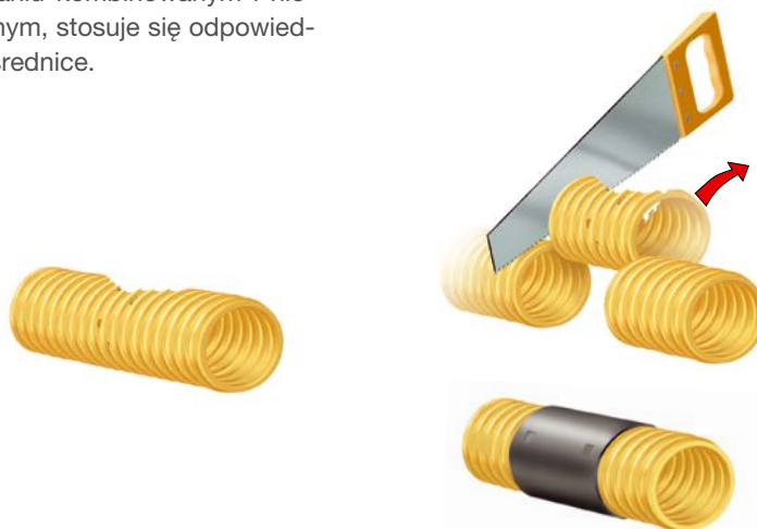
Usunięcie uszkodzonego odcinka rury karbowanej z PCV
