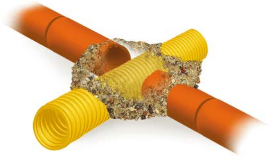
Połączenie sączka nowego z PVC ze starym sączkiem ceramicznym
