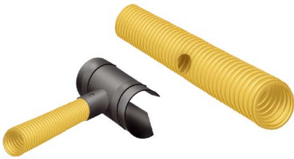
Górno-boczne połączenie sączka ze zbieraczem
